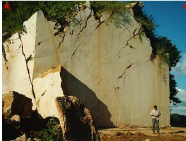
Perfil de extracción con hilo de diamante en la cantera Gallo Crudo.
